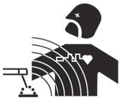
Le courant électrique passant à travers n'importe quel conducteur produit des champs électriques et magnétiques (EMF) localisés. Le courant de soudage produit un champ électromagnétique autour du circuit de soudage et du matériel de soudage.
