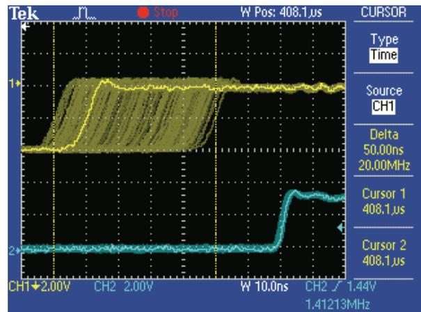
La capture d'écran montre un signal SPDIF avec une gigue extrême d'environ 50 ns (ligne du haut, jaune). Grâce à la SteadyClock, ce signal se transforme en une horloge avec moins de 2 ns de gigue (ligne du bas, bleue). Le signal traité par la SteadyClock n'est bien sûr pas utilisé uniquement en interne, mais sert également à synchroniser les sorties numériques. Par conséquent, le signal rafraîchi et débarrassé de sa gigue peut être utilisé comme horloge de référence sans hésitation.
