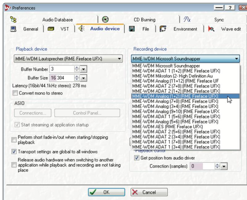
Augmenter le nombre et/ou la taille des mémoires tampons (buffers) audio peut empêcher les ruptures de flux de signal audio, mais augmente aussi le temps de latence c'est-à-dire que la sortie est retardée. Pour une reproduction synchronisée de l'audio et du MIDI (ou similaire), cochez "Get position from audio driver" (Obtenir la position du pilote audio).
