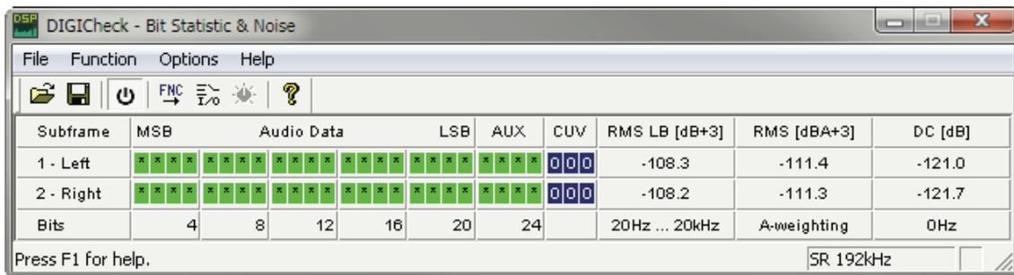
Si vous limitez la plage de mesure aux fréquences comprises entre 20 Hz et 20 kHz (ce que l'on appelle la bande passante audio), la valeur redevient -109 dB. Cela peut être vérifié avec le DIGICheck RME. La fonction **Bit Statistic & Noise** mesure le bruit de fond avec bande passante limitée (*Limited Bandwidth*), ignorant la composante continue du courant et les ultrasons.
