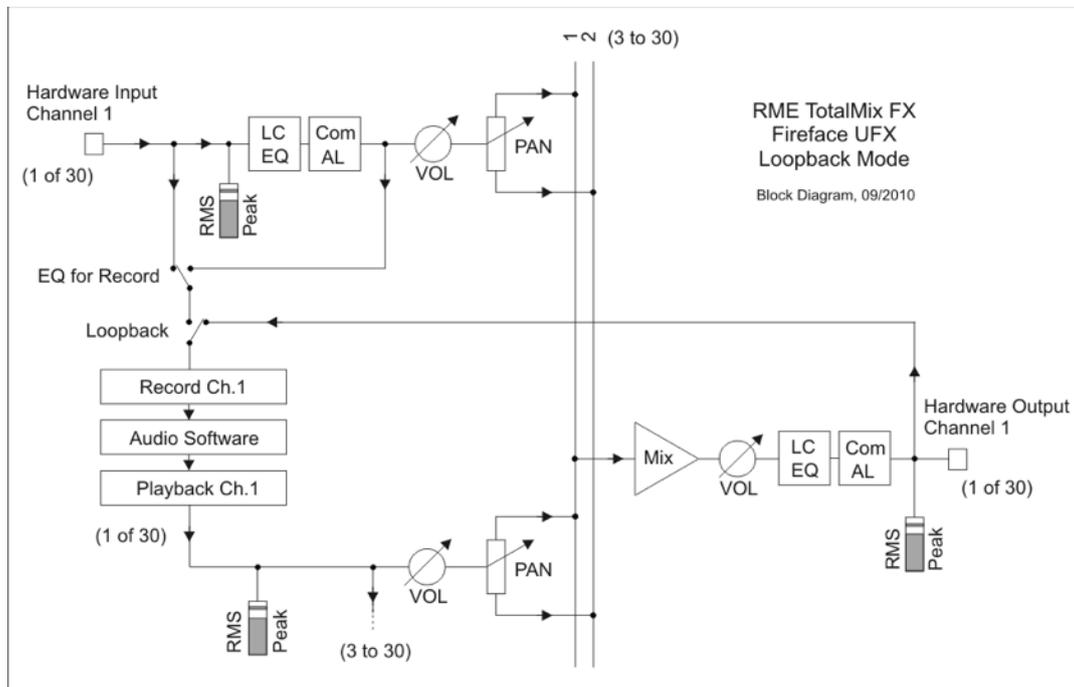
Le schéma synoptique montre comment le signal entrant du logiciel est reproduit et réinjecté depuis la sortie physique dans l'entrée du logiciel.
