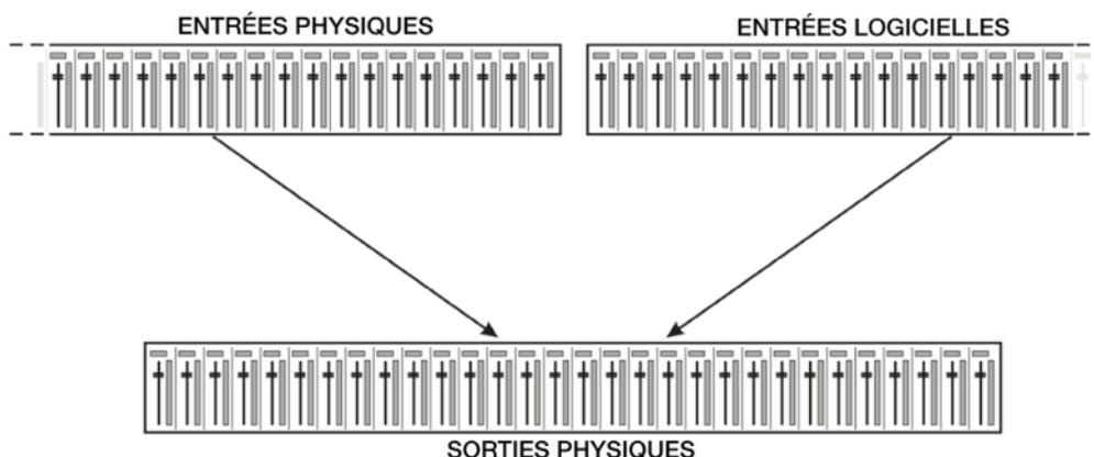
TotalMix peut être utilisé comme dans l'illustration ci-dessus (options de visualisation **2 Rows** ou "2 rangées"). Le canal d'entrée doit être placé au-dessus du canal de sortie correspondant. Toutefois, le réglage par défaut est un alignement vertical en 3 rangées comme celui d'une console de mixage Inline, afin que la rangée de *lecture logicielle* corresponde au retour magnétophone (*Tape Return*) d'une véritable table de mixage.
