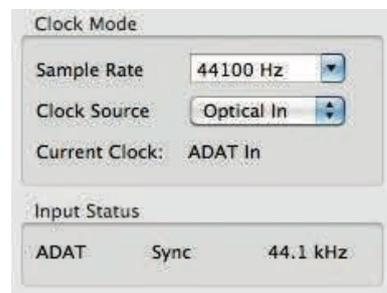
La technologie **SyncCheck** exclusive de RME (pour la première fois exploitée dans l'Hammerfall), permet un contrôle et un affichage simple d'emploi du statut d'horloge actuel. *SyncCheck* indique s'il y a ou non un signal acceptable (Lock, No Lock) pour chaque entrée (Word Clock, ADAT, AES) ou s'il y a un signal valable et synchrone (Sync). L'horloge de référence est affichée dans le champ *Clock Mode* (mode d'horloge). Voir chapitre 32.1.
