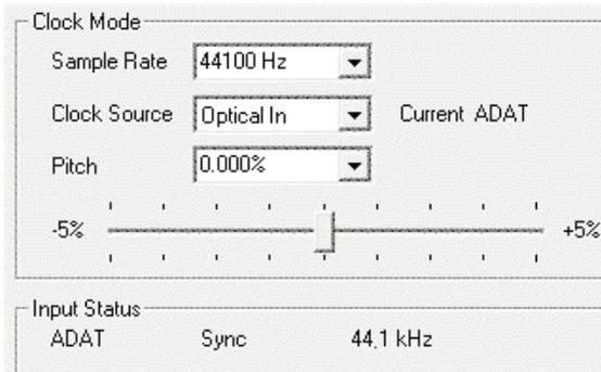
Par conséquent, configurer le logiciel pour un enregistrement numérique est un jeu d'enfant. Après avoir sélectionné l'entrée correcte, la Fireface 802 affiche la fréquence d'échantillonnage actuelle. Ce paramètre peut alors être changé dans le dialogue d'attributs audio (ou réglage similaire) de l'application.
