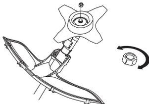
Pose: serrer l'écrou dans le sens contraire de la rotation de l'équipement de coupe. Dépose: desserrer l'écrou dans le sens de la rotation de l'équipement de coupe.
