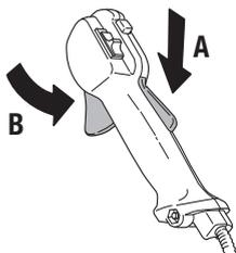
Vérifier d'abord que la commande de l'accélération est bloquée en position de ralenti quand le blocage de l'accélération est en position initiale.
