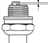
(553RS) Si la puissance de la machine est trop faible, si la machine est difficile à mettre en marche ou si le ralenti est irrégulier, toujours commencer par contrôler l'état de la bougie avant de prendre d'autres mesures. Si la bougie est encrassée, la nettoyer et vérifier que l'écartement des électrodes est de 0,6-0,7 mm. Remplacer la bougie une fois par mois ou plus souvent si nécessaire.
